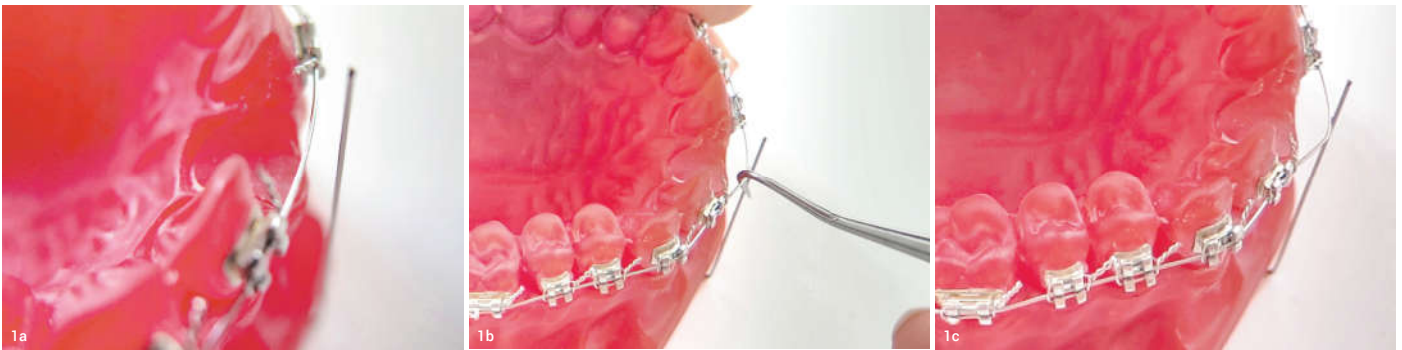
Abb. 1a-c: Identischer Versuchsaufbau wie in der Studie von Alobeid et al.: Ein Kunststoffmodell (Palavit G 4004, Heraeus Kulzer, Hanau, Deutschland) wurde aus einem dublierten Frasco Modell (Frasaco, Tettmang, Deutschland) eines normalen Oberkiefers hergestellt. Der obere linke mittlere Schneidezahn wurde entfernt. Das Modell wurde mit konventionellen Brackets mit einem .022" Bracketslot beklebt (GAC Twin, Dentsply Sirona, Charlotte, USA). Ein .014" Thermalloy-Nickel-Titan-Bogen wurde eingesetzt (RMO, Denver, USA). Zum Einligieren mit Drahtligaturen wurde ein Nadelhalter verwendet. Dabei wurde die Ligatur zunächst fest angezogen und dann eine Umdrehung gelockert, um dem Bogen Bewegungsfreiheit zu geben (a). Ein Referenz-
